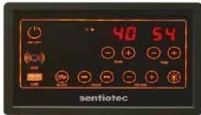
Tryck på **På/Av** för att slå på styrningen. Värmeelementen påbörjar uppvärmningen. Temperaturen i kabinen och körtiden visas. Körtiden aktiveras automatiskt till 60 minuter eller till den senast valda tiden. Tryck på **På/Av** igen om du vill stänga av alla funktioner (värmeelement, belysning och musik).
